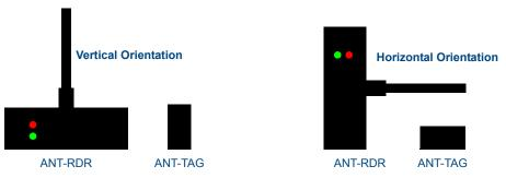
FIG. 5 ANT-RDR / ANT-TAG Antenna Orientation
